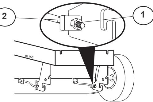
SE För att få bästa klippresultat skall klippaggregatets framkant (B) vara ca 10 mm lägre än bakkanten (A). Justera på följande sätt för att höja bakkanten:
