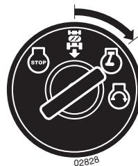
Engine "ON" (Normal användning)
