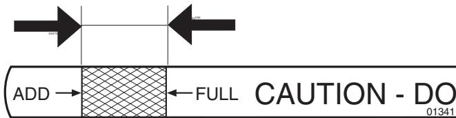
**SE** Oljenivån skall ligga mellan de båda markeringarna på stickan. Om så inte är fallet skall motorolja SAE 30 fyllas till "FULL"-markeringen. Vinterstid (under fryspunkten) skall motorolja SAE 5W-30 användas.
