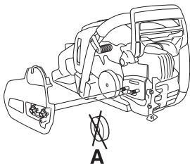
Asenna terälevy teräpultteihin. Aseta terälevy takimmaiseen asentoonsa. Aseta ketju ketjupyörälle ja terälevyn ohjausuraan. Aloita terälevyn yläpuolelta.
