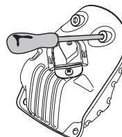
Noen lyddempere er utstyr med et spesielt gnistfangernett. Hvis maskinen er utstyr med en slik lyddemper, bør nettet rengjøres en gang i uken. Dette gjøres enklast med en stålborste. Et tilstoppet nett fører til at motoren går varm med alvorlig motorskade som følge.
