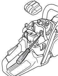
Et spesielt beskyttelseslokke er tilgjengelig for montering på startmotorhuset ved temperaturer under -5 °C og/eller arbeid i snø.
