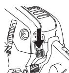
Motoren standses ved at trykke start/stop-knappen ned.
