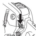
Motoen stanses ved at start/stopp-hendelen trykkes ned. OBS! Start/Stopp-kontakten går automatisk tilbake til kjørrestilling. For å unngå ufrivillig start, må tennpluggen derfor alltid fjernes fra tennpluggen når maskinen ikke er under tilsyn.
