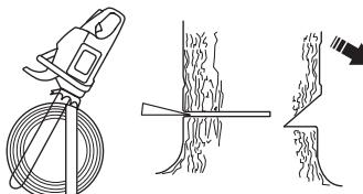
Hovedskåret skal avsluttes parallelt med styreskårlinjen slik at avstanden mellom dem er minst 1/10 av stammens diameter. Den delen av stammen som ikke er gjennomsagt, kalles brytekant.
