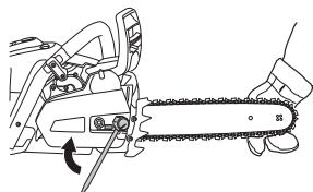
Uuden ketjun kireys on tarkastettava usein ketjun sisäänaajan aikana. Tarkasta ketjun kireys säännöllisesti. Oikein kiristetty ketju takaa hyvän leikkutehon ja pitkän kestoän.
