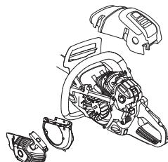
Puhdista jäähditysjärjestelmä harjalla kerran viikossa, vaikeammassa käyttöolosuhteissa useammin. Likainen tai tukkeentunut jäähditysjärjestelmä johtaa koneen ylikuumenemiseen, josta on seurauksena sylinterin ja mänän vauroituminen.
