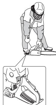
Eftersom kedjebromsen fortfarande är tillslagen måste motorns varvtal så snart som möjligt ner till tomgång, vilket uppnås genom att snabbt koppla ur gasspärren. Därigenom undviker du onödigt slitage på koppling, kopplingstrumma och bromsband.
