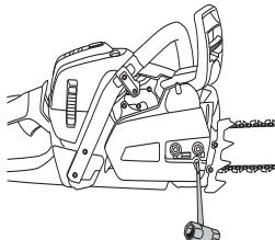
Kæden er korrekt spændt, når den ikke hænger slapt ned på sværdets underside og stadig kan trækkes rundt med hånden. Spænd sværdmøtrikkerne fast med kombinøglen, samtidig med at sværdspidsen holdes opad.
