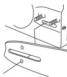
Stram kjedet ved å skru kjedestrammerskruen med klokken med kombinøkkelen. Kjedet skal strammes til det ikke henger ned på undersiden av sverdet. Se anvisninger under overskriften Stramming av sagkjedet.
