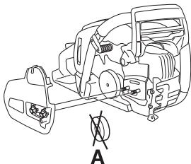
Montér sværdet over sværboltene. Placér sværdet i dets bagerste stilling. Placér kæden over kædedrivhjulet og i sværdsportet. Begynd på sværdets overside.
