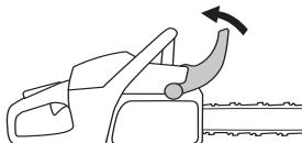
Skru ut sverdmutrene og demonter koplingsdekselet (kjedebremsen). Fjern transportbeskyttelsen (A).
