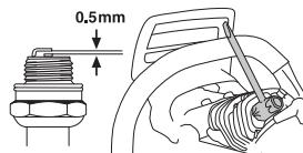
Bemærk! Brug altid anbefalet tændrørstype! Forkert tændrør kan ødelægge stempel/cylinder. Kontrollér, at tændrøret har såkaldt radiostøjdæmpning.
