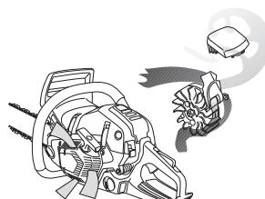
**VIGTIG!** For å opprettholde centrifugalrensingers funksjon, må den rengjøres og vedlikeholdes kontinuerlig. Rengjør luftinntaket til startmotoren, vifteskovlene på svinghjulet, rommet rundt svinghjulet, inntaksrøret og forgasserrømmet.
