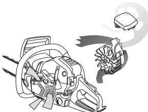
**VIGTIGT!** For at bevare centrifugalrensningens funktion skal man udføre kontinuerlig pleje og vedligeholdelse. Rens startaggregatets luftindtag, svinghjulets ventilatorflanger, området omkring svinghjulet, indugsningsrøret og karburatorrummet.
