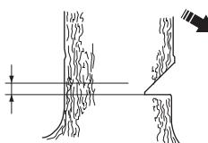
Sett i barkstøtten (hvis en slik er montert) bak brytekanten. Sag med full gass og før sagkjedet/sverdet sakte inn i treet. Vær på vakt mot at treet beveger seg i motsatt retning av det som er valgt som fallretning. Sett i en fellekile eller brytejern i hovedskåret så snart skjæreedybden tillater det.
