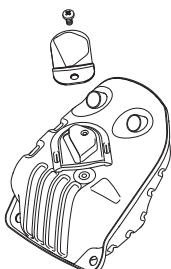
Lyddæmperen er beregnet til at dæmpe lydniveauet og til at lede udstødningsgasserne væk fra brugeren. Udstødningsgasserne er varme og kan indeholde gnister, som kan forårsage brand, hvis udstødningsgasserne rettes mod et tørt og brændbart materiale.
