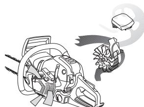
**TÄRKEÄ!** Keskipakoispuhdistuksen tehon säilyttämiseksi on huolehdittava säännöllisestä huollossa. Puhdista käynnistimen ilmanottoaukot, vauhtipyörän tuuletinsiivet, vauhtipyörän ympäristö, imuputki ja kaasutintila.
