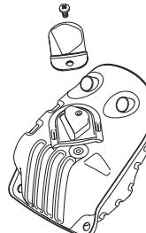
Lyddempere er utformet for å dempe lydnivået og for å lede avgassene bort fra brukeren. Avgassene er varme og kan inneholde gnister som kan forårsake brann hvis gassene rettes mot et tørt og brennbart materiale.
