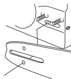
Kiristä ketju kiertämällä ketjun kiristysruuvia yhdistelmäävaimella myötäpäivään. Ketjua on kiristettävä sen verran, ettei se roiku löysällä terälevyn alapuolella. Katso otsikon Teräketjun kiristäminen alla annetut ohjeet.
