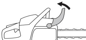
Ruuvaa terämutterit irti ja irrota kytikkokotelo (ketujarru). Poista kuljetussuoja (A).
