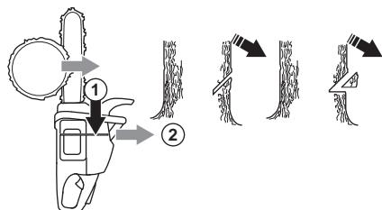
Retningsnissnittdybden skal være 1/4 af stammens diameter, og vinklen mellem over- og undersnit skal være mindst 45°.
