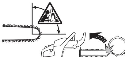
Å sage med sverdets underside, dvs. å sage fra sagobjekts overside og ned, kalles å sage med dragende sagkjede. Da dras motorsagen mot treet, og motorsagkroppens forkant blir en naturlig støtte mot stammen. Saging med dragende sagkjede gir brukeren bedre kontroll over motorsagen og over hvor sverdets kastriskosektor befinner seg.
