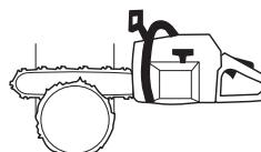
Käytössä on menetelmiä, joilla voidaan kaataa terälevyn pituutta paksumpia puita. Näitä menetelmiä käytettäessä on erittäin suuri vaara, että terälevyn takapotkusektori osuu johonkin.
