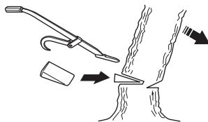
Vi rekommenderar användande av en svärds längd som överstiger trädetets stamdiometer, så att fäll- och riktskär kan utföras med ett s.k. "enkelt sågsnitt". Se anvisningar
