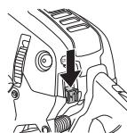
Motorn stannas genom att start/stopp reglaget trycks ner. OBS! Start/Stopp kontakten återgår automatiskt till körläge. För att undvika ofrivillig start, måste därför alltid tändhatten avlägsnas från tändstiftet när maskinen inte är under uppsikt.
