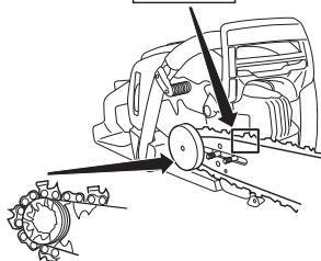
Tarkasta, että hammaslenkkien teräsärmät ovat eteenpäin terälevyn yläpuolella.
