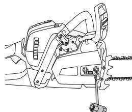
Kedjan är korrekt spänd när den inte hänger slak på svärdets undersida och fortfarande kan dras runt lätt för hand. Drag fast svärdsmuttrarna med kombinyckeln samtidigt som svärdspetsen hålls upp.
