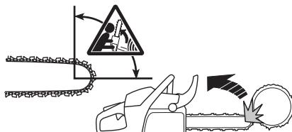
Att såga med svärdets undersida, dvs. att såga från sågobjektets ovansida och ner, kallas att såga med dragande sågkedja. Då dras motorsågen mot trädet och motorsågkroppens framkant blir ett naturligt stöd mot stammen. Sågning med dragande sågkedja ger
