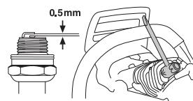
Bemerk! Bruk alltid anbefalt type tennplugg! Feil tennplugg kan ødelegge stempel/sylinder. Påse at tennpluggen har såkalt radiostøyfilter.
