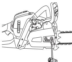
Ketjun kireys on oikea, kun se ei roiku löysällä terälevyn alapuolella ja liikkuu kevyesti käsin pyöritettäessä. Kiristä terämutterit yhdistelmäävaimella pitäen samalla terälevyn kärkeä ylhäällä.
