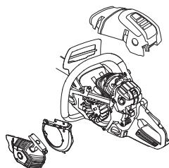
Rengjør kjølesystemet med en børste en gang i uken, ved vanskelige forhold oftere. Et tilsmusset eller tett kjølesystem fører til at maskinen overoppphetes, noe som forårsaker skader på sylinder og stempel.
