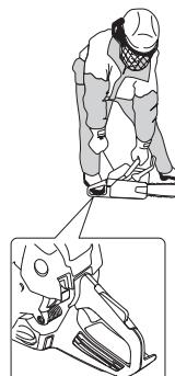
Da kædebremsen stadig er slæt til, skal motorens omdrejningstal hurtigst muligt ned i tomgang, hvilket opnås ved hurtigt at koble gaslåsen ud. Derved undgår du unødig slitage på kobling, koblingstromle og bremsebånd.
