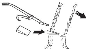
Vi anbefaler bruk av en sverdlengde som er større enn trees diameter, slik at hoved- og styreskår kan utføres med et såkalt "enkelt sagskår". Se anvisninger under overskriften Tekniske data ang. hvilke sverdlengder som anbefales for din motorsagsmodell.
