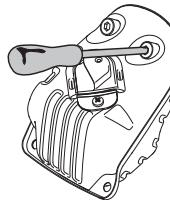
Visse lyddæmpere er udstyret med et specielt gnisifangeret. Hvis din maskine er udstyret med en sådan lyddæmper, bør nettet rengøres en gang om ugen. Dette gøres bedst med en stålborste. Et tilstoppet net medfører, at motoren kører varm med alvorlig motorskade til følge.
