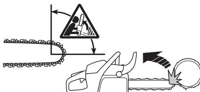
At save med sværdets underside, dvs. save fra objektets overside og ned, kaldes at save med trækende savkæde. Da trækkes motorsaven mod træet og motorsavskroppens forkant bliver en naturlig støtte mod stammen. Savning med trækende savkæde giver brugerken bedre kontrol over motorsaven, og man ved, hvor sværdets kastriskoområde befinder sig.
