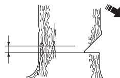
Sett i barkstøtten (hvis en slik er montert) bak brytekanten. Sag med full gass og før sagkjedet/sverdet sakte inn i treet. Vær på vakt mot at treet beveger seg i motsatt retning av det som er valgt som fallretning. Sett i
