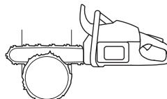
Käytössä on menetelmiä, joilla voidaan kaataa terälevyn pituutta paksumpia puita. Nämä menetelmät käytettäessä on erittäin suuri vaara, että terälevyn takapotkusektori osuu johonkin.
