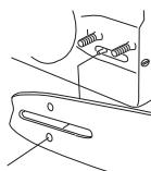
Stram kjedet ved å skru kjedestrammerskruen med klokken med kombinøkkelen. Kjedet skal strammes til det ikke henger ned på undersiden av sverdet. Se anvisninger under overskriften Stramming av sagkjedet.
