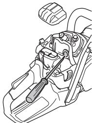
Et spesielt beskyttelseslokke er tilgjengelig for montering på startmotorhuset ved temperaturer under -5 °C og/eller arbeid i snø.
