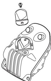
Lyddæmperen er beregnet til at dæmpe lydniveauet og til at lede udstødningsgasserne væk fra brugerne. Udstødningsgasserne er varme og kan indeholde gnister, som kan forårsage brand, hvis udstødningsgasserne rettes mod et tørt og brændbart materiale.
