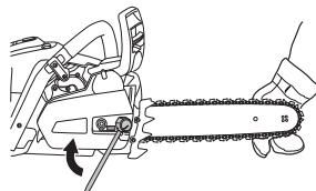
På et nytt kjede må kjedespenningen kontrolleres ofte til kjedet er kjørt inn. Kontroller kjedespenningen regelmessig. Riktig kjede betyr god skjærekapasitet og lang levetid.
