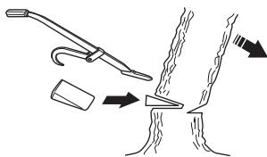
Vi anbefaler at bruge en sværdlængde, som er længere end træets diameter, så fælde- og retningssnit kan udføres med et såkaldt 'enkelt savsnit'. Se anvisningerne i afsnittet Tekniske data for at få oplysninger om, hvilke sværdlængder der anbefales til din motorsavsmodel.
