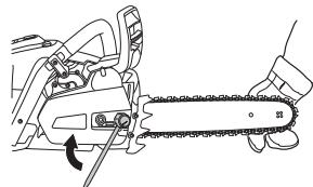
Uuden ketjun kireys on tarkastettava usein ketjun sisäänajon aikana. Tarkasta ketjun kireys säännöllisesti. Oikein kiristetty ketju takaa hyvän leikkutehon ja pitkän kestoän.
