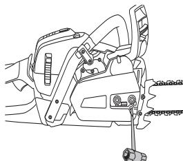
Kæden er korrekt spændt, når den ikke hænger slapt ned på sværdets underside og stadig kan trækkes rundt med hånden. Spænd sværdmøtrikkerne fast med kombinøglen, samtidig med at sværdspidsen holdes opad.
