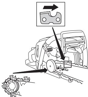
Tarkasta, että hammaslenkkien teräsärmät ovat eteenpäin terälevyn yläpuolella.
