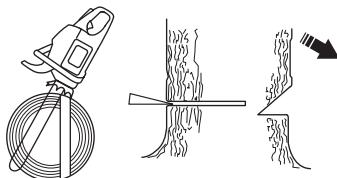
Fældesnitt skal afsluttes parallelt med retningssnitlinjen, så afstanden mellem de to er mindst 1/10 af stammens diameter. Den ikke gennemsavede del af stammen kaldes brudpunktet.
