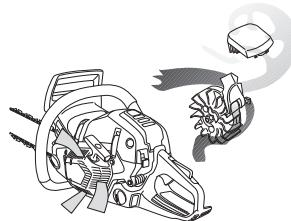
**VIGTIG!** For å opprettholde centrifugalrensingers funksjon, må den rengjøres og vedlikeholdes kontinuerlig. Rengjør luftinntaket til startmotoren, vifteskovlene på svinghjulet, rommet rundt svinghjulet, intaksrøret og forgasserrommet.
