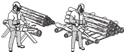
**Stokken ligger på bakken.** Det er ingen fare for at sagkjetet skal klemmes fast eller at sagobjektet skal splintres. Det er imidlertid stor fare for at sagkjetet treffer bakken etter gjennomsaging.
