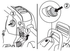
Tag fat i det forreste håndtag med venstre hånd. Placer højre fod i støvleåbningen igennem den nederste del af det bagste håndtag, så maskinen trykkes imod jorden.
