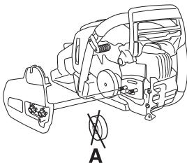
Montér sværdet over sværboltene. Placér sværdet i dets bagerste stilling. Placér kæden over kædedrivhjulet og i sværdsporet. Begynd på sværdets overside.
