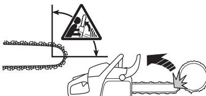
Å sage med sverdets underside, dvs. å sage fra sagobjekts overside og ned, kalles å sage med dragende sagkjede. Da dras motorsagen mot treet, og motorsagkroppens forkant blir en naturlig støtte mot stammen. Saging med dragende sagkjede gir brukeren bedre kontroll over motorsagen og over hvor sverdets kastriskosektor befinner seg.
