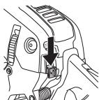
**OBSERVERA!** Start/Stopp kontakten återgår automatiskt till körläge. För att undvika oprivillig start, måste därför alltid tändhatten avlägsnas från tändstiftet vid montering, kontroll och/eller underhåll.
