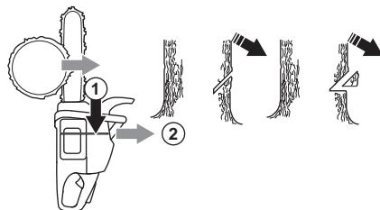
Retningssnitdybden skal være 1/4 af stammens diameter, og vinklen mellem over- og undersnit skal være mindst 45°.
