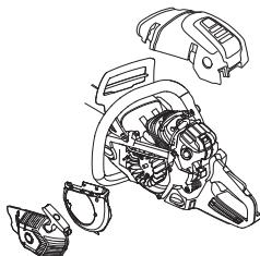
Puhdista jäähditysjärjestelmä harjalla kerran viikoissa, vaikeammassa käyttöolosuhteissa useammin. Likainen tai tukkeentunut jäähditysjärjestelmä johtaa koneen ylikuumenemiseen, josta on seurausena sylinterin ja mänän vauroituminen.
