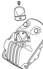
Lyddempere er utformet for å dempe lydnivået og for å lede avgassene bort fra brukeren. Avgassene er varme og kan inneholde gnister som kan forårsake brann hvis gassene rettes mot et tørt og brennbart materiale.
