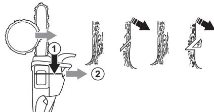
Dybden på styreskåret skal være 1/4 av stammens diameter og vinkelen mellom over- og underskjær minst 45°.
