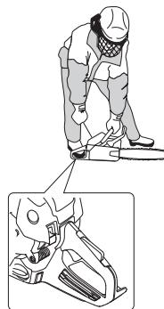
Eftersom kedjebromsen fortfarande är tillslagen måste motorns varvtal så snart som möjligt ner till tomgång, vilket uppnås genom att snabbt koppla ur gasspärren. Därigenom undviker du onödig slitage på koppling, kopplingstrumma och bromsband.
