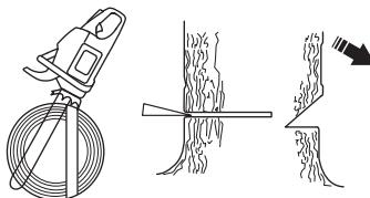
Hovedskåret skal avsluttes parallelt med styreskårlinjen slik at avstanden mellom dem er minst 1/10 av stammens diameter. Den delen av stammen som ikke er gjennomsagd, kalles brytekant.
