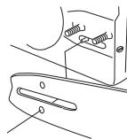
Spænd kæden ved at bruge kombinøglen til at skru kædestrammerskruen med uret. Kæden skal strammes til, så den ikke hænger slapt ned på sværdets underside. Se anvisningerne i afsnittet **Stramning af savkæden**.
