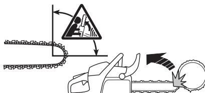
Att såga med svärdets undersida, dvs. att såga från sågobjektets ovansida och ner, kallas att såga med dragande sågkedja. Då dras motorsågen mot trädet och motorsågkroppens framkant blir ett naturligt stöd mot stammen. Sågning med dragande sågkedja ger användaren bättre kontroll över motorsågen samt över var svärdets kastrisksektor befinner sig.
