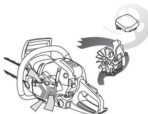
**TÄRKEÄÄ!** Keskipakoispuhdistuksen tehon säilyttämiseksi on huolehdittava säännöllisestä huollossa. Puhdista käynnistimen ilmanottoaukot, vauhtipyörän tuuletinsiivet, vauhtipyörän ympäristö, imuputki ja kaasutintila.
