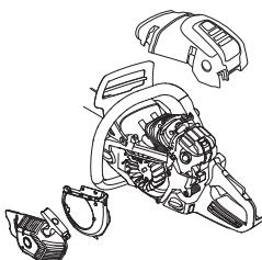
Rengjør kjølesystemet med en børste en gang i uken, ved vanskelige forhold oftere. Et tilsmusset eller tett kjølesystem fører til at maskinen overoppphetes, noe som forårsaker skader på påylinder og stempel.
