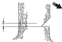
Placer barkstøtten (hvis den er monteret) bag brudpunktet. Sav med fuld gas, og før savkæden/sværdet langsomt ind i træet. Vær opmærksom på, om træet bevæger sig i modsat retning i forhold til den valgte faldretning. Sæt en fældekile i eller et brækjern i fældesnittet, så snart snitdybden tillader det.
