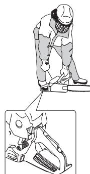
Da kædebremsen stadig er slæt til, skal motorens omdrejningstal hurtigt muligt ned i tomgang, hvilket opnås ved hurtigt at koble gaslåsen ud. Derved undgår du unødig slitage på kobling, koblingstromle og bremsebånd.
