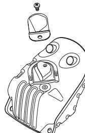
Ljuddämparen är utformad för att dämpa ljudnivån och för att leda avgaserna bort från användaren. Avgaserna är heta och kan innehålla gnistor vilka kan orsaka brand om avgaserna riktas mot ett torrt och brännbart material.
