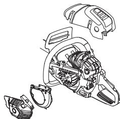
Rens kølesystemet med en børste en gang om ugen, under støvfylde forhold oftere. Et snavset eller tilstoppet kølesystem medfører overopvarmning af maskinen med skader på cylinderen og stemplet til følge.
