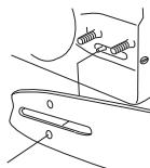
Spän kedjan genom att med hjälp av kombinyckeln skruva kedjespännarskruven medurs. Se anvisningar under rubrik Sträckning av sågkedjan.
