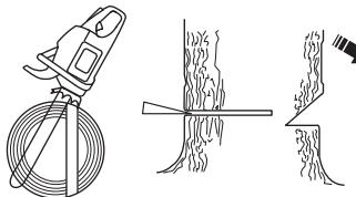
Fällskäret skall avslutas parallellt med riktskärslinjen så att avståndet mellan de båda är minst 1/10 av stamdiometern. Den icke genomsågade delen av stammen kallas brytmån.
