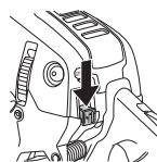
Motoren standses ved at trykke start/stop-knappen ned.
