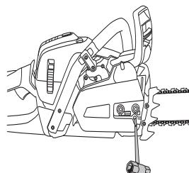
Kedjan är korrekt spänd när den inte hänger slak på svärdets undersida och fortfarande kan dras runt lätt för hand. Drag fast svärdsmuttrarna med kombinyckeln samtidigt som svärdspetsen hålls upp.
