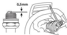
Bemærk! Brug altid anbefalet tændrørstype! Forkert tændrør kan ødelægge stempel/cylinder. Kontrollér, at tændrøret har såkaldt radiostøjdæmpning.
