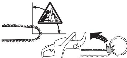
Kast färdas alltid i svärdsplanets riktning. Vanligast är att motorsåg och svärd kastas uppåt och bakåt mot användaren. Dock förekommer andra kastriktningsar beroende på vilket läge motorsågen har i det ögonblick svärdets kastrisksektor kommer i kontakt med ett föremål.
