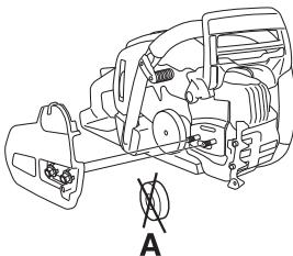
Asenna terälevy teräpultteihin. Aseta terälevy takimaiseen asentoonsa. Aseta ketju ketjupöyrälle ja terälevyn ohjausuraan. Aloita terälevyn yläpuolelta.
