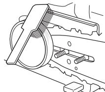
Kontroller jevnlig at bremsebåndet er minst 0,6 mm tykt på det mest slitte stedet.
