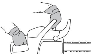
Gi full gass og aktiver kjedebremsen ved å vri venstre håndledd mot kastbeskyttelsen. Ikke slipp det fremste håndtaket. **Kjedet skal stanse umiddelbart.**
