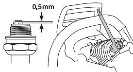
Observera! Använd alltid rekommenderad tändstiftstyp! Felaktigt tändstift kan förstöra kolv/cylinder. Se till att tändstiftet har s.k. radioavstörning.
