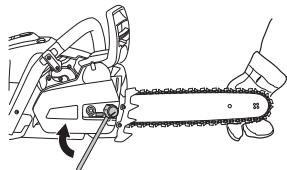
På en ny kæde skal kædestramningen kontrolleres ofte, indtil kæden er kørt til. Kontrollér kædestramningen regelmæssigt. Korrekt kæde betyder god skærekapacitet og lang levetid.
