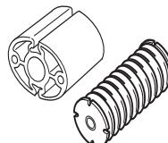
Compruebe regularmente que los elementos antivibraciones no estén agrietados o deformados. Controle que los amortiguadores de vibraciones estén enteros y bien sujetos.
