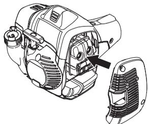
Nekateri modeli dušilcev so opremljeni s posebno mrežico za gašenje isker. Če je vaš stroj opremljen s dušilcem tega tipa, morate mrežico enkrat tedensko očistiti. V ta namen uporabljajte žično krtačo. Na dušilih brez katalizatorja je mrežico za lovljenje isker priporočljivo očistiti in po potrebi
