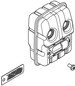
Sicherstellen, dass der Funkenfänger korrekt angeschraubt ist.
