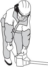
**ACHTUNG!** Kein Körperteil darf auf die markierte Fläche geraten. Der Kontakt kann zu Hautverbrennungen oder elektrischen Schlägen führen, wenn die Zündkappe defekt ist. Stets Handschuhe tragen. Niemals eine Maschine mit defekter Zündkappe verwenden.
