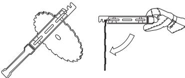
Die Schneidausrüstung auf Beschädigung und Risse kontrollieren. Beschädigte Schneidausrüstungen sind grundsätzlich auszutauschen.
