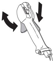
Glej poglavje pod naslovom Vžig. Vžgite stroj in mu dajte polni plin. Izpustite plinsko ročico in se prepričajte, da se rezilni priključek ustavi in obmiruje. Če se rezilni priključek vrtil, ko je plinska ročica v legi prostega teka, preglejte nastavitev uplinjača v prosti legi. Glejte navodila v poglavju Vzdrževanje.
