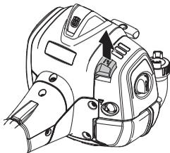
Razstavite ohišje filtra in odstranite filter. Operite ga v topli milnici. Z zrakom ali krtačo očistite tudi notranjost pokrova filtra. Prepričajte se, da je filter suh, predno ga ponovno montirate.
