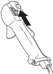
Den Motor starten und kontrollieren, ob der Motor stoppt, wenn der Stopschalter in Stoppstellung geführt wird.
