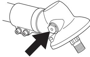
Das Schmiermittel im Getriebegehäuse braucht normalerweise nur bei evtl. Reparaturen gewechselt zu werden.
