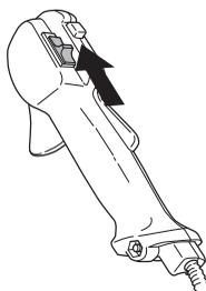
Vžgite motor in preverite, če se ustavi, ko izklopno stikalo potisnete v položaj STOP.
