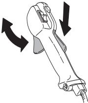
Siehe die Anweisungen unter der Überschrift Start. Gerät starten und Vollgas geben. Den Gashebel loslassen und kontrollieren, ob die Schneidausrüstung völlig zum Stillstand kommt. Wenn die Schneidausrüstung rotiert, während sich der Gashebel in Leerlaufstellung befindet, ist die Leerlaufeinstellung des Vergasers zu kontrollieren. Siehe die Anweisungen unter der Überschrift Wartung.
