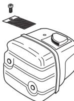
O silenciador é configurado para abafrar o nível de ruído e para conduzir os gases de escape para longe do utilizador. Os gases de escape são quentes e podem conter faíscas que podem causar incêndios, se os gases forem dirigidos contra um material seco e inflamável.
