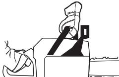
Acelere al máximo y active el freno de cadena girando la muñeca izquierda hacia la protección contra reculadas.
