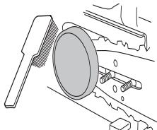
Controle periodicamente se restam pelo menos 0,6 mm da espessura da cinta nas partes de maior desgaste.
