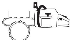
Há métodos para abate de árvores com os diâmetros do tronco maiores do que o comprimento da lâmina. Esses métodos acarretam o grande perigo de que o sector de risco de retrocesso da lâmina entre em contacto com algum objecto.
