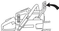
Desenrosque las tuercas de la espada y saque la cubierta del embrague (el freno de cadena). Saque la protección de transporte (A).
