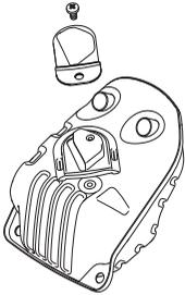
Lydtemperen er utformet for å dempe lydnivået og for å lede avgassene bort fra brukeren. Avgassene er varme og kan inneholde gnister som kan forårsake brann hvis gassene rettes mot et tørt og brennbart materiale.
