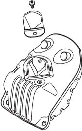
Lydæmperen er beregnet til at dæmpe lyd-niveauet og til at lede udstødningsgasserne væk fra brugeren. Udstødningsgasserne er varme og kan indeholde gnister, som kan forårsage brand, hvis udstødningsgasserne rettes mod et tørt og brændbart materiale.
