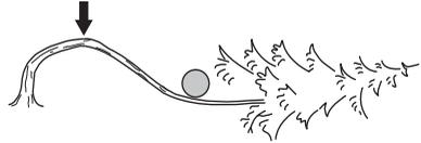
Afgør, hvordan du på den sikreste måde kan frigøre spændingen, og om du kan klare det. Ved særligt komplicerede situationer er den eneste sikre metode helt at undlade at bruge motorsaven og i stedet bruge et spil.
