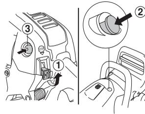
Tag fat i det forreste håndtag med venstre hånd. Placer højre fod i støvleåbningen igennem den nederste del af det bageste håndtag, så maskinen trykkes imod jorden.
