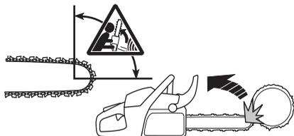
Att såga med svärdets undersida, dvs. att såga från sågobjektets ovasida och ner, kallas att såga med dragande sågkedja. Då dras motorsågen mot trädet och motorsågkroppens framkant blir ett naturligt stöd mot stammen. Sågning med dragande sågkedja ger användaren bättre kontroll över motorsågen samt över var svärdets kastrisksektor befinner sig.
