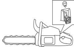
BEMÆRK! Start/Stop-kontakten går automatisk tilbage til køreposition. For at undgå utilsigtet start skal tændhætten altid fjernes fra tændrøret ved montering, kontrol og/eller vedligeholdelse.
