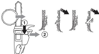
Retningsssnitdybden skal være 1/4 af stammens diameter, og vinklen mellem over- og undersnit skal være mindst 45°.
