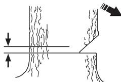
Sett i barkstøtten (hvis en slik er montert) bak brytekanten. Sag med full gass og før sagkjedet/sverdet sakte inn i treet. Vær på vakt mot at treet beveger seg i motsatt retning av det som er valgt som fallretning. Sett i en fellekile eller et brytejern i hovedskåret så snart skjæredybden tillater det.
