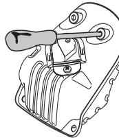
Visse lyddæmpere er udstyret med et specielt gnistfangernet. Hvis din maskine er udstyret med en sådan lyddæmper, bør nettet rengøres en gang om ugen. Dette gøres bedst med en stålborste. Et tilstoppet net medfører, at motoren kører varm med alvorlig motorskade til følge.
