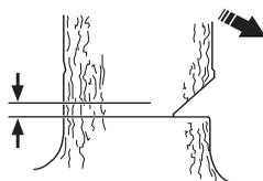
Sätt i barkstödet (om något är påmonterat) bakom brytmånen. Såga med fullgas och för sågkedjan/svärdet sakta in i trädet. Var observant på om trädet rör sig i motsatt riktning till vald fallriktning. Sätt i en fällkil eller ett brytjärn i fällskåret så snart skärdjupet tillåter.
