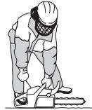
**Trykk ned den røde choke-regulatoren** umiddelbart når motoren tenner, noe som høres ved en "poff"-lyd. Fortsett å dra med hurtige rykk i snoren til motoren starter.
