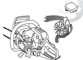
**VIGTIGT!** For at bevare centrifugalrensningens funktion skal man udføre kontinuerlig pleje og vedligeholdelse. Rens startaggregatets luftindtag, svinghjulets ventilatorflanger, området omkring svinghjulet, indsugningsrøret og karburatorrummet.
