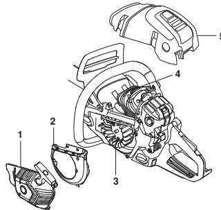
Rengjør kjølesystemet med en børste en gang i uken, ved vanskelige forhold oftere. Et tilsusset eller tett kjølesystem fører til at maskinen overopphetes, noe som forårsaker skader på sylinder og stempel.
