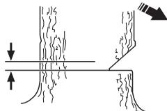
Placer barkstøtten (hvis den er monteret) bag brudpunktet. Sav med fuld gas, og før savkæden/sværdet langsomt ind i træet. Vær opmærksom på, om træet bevæger sig i modsat retning i forhold til den valgte faldretning. Sæt en fældekil eller et brækjern i fældesnittet, så snart snitdybden tillader det.
