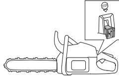
OBSERVERA! Start/Stop kontakten återgår automatiskt till köräge. För att undvika ofrivillig start, måste därför alltid tändhatten avlägsnas från tändstiftet vid montering, kontroll och/eller underhåll.
