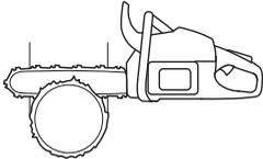
Käytössä on menetelmiä, joilla voidaan kaataa terälevyn pituutta paksumpia puita. Näitä menetelmiä käytettäessä on erittäin suuri vaara, että terälevyn takapotkusektori osuu johonkin.
