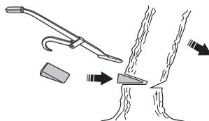
Vi anbefaler bruk av en sverdlengde som er større enn trets diameter, slik at hoved- og styreskår kan utføres med et såkalt "enkelt sagskår". Se anvisninger under
