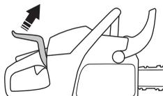
Bær eller heng aldri sagen i bøylene! Det kan skade mekanismen og sette kjedebremsen ut av funksjon.
