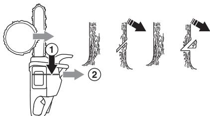
Dybden på styreskåret skal være 1/4 av stammens diameter og vinkelen mellom over- og underskjær minst 45°.
