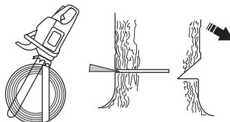
Hovedskåret skal avsluttes parallelt med styreskårlinjen slik at avstanden mellom dem er minst 1/10 av stammens diameter. Den delen av stammen som ikke er gjennomsgått, kalles brytekant.
