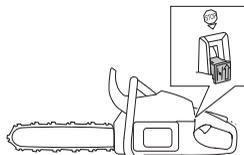
**OBSERVERA!** Start/Stopp kontakten återgår automatiskt till körläge. För att undvika ofrivillig start, måste därför alltid tändhatten avlägsnas från tändstiftet när maskinen inte är under uppsikt.
