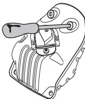
Noen lyddempere er utstyrt med et spesielt gnistfangernet. Hvis maskinen er utstyrt med en slik lyddemper, bør nettet rengjøres en gang i uken. Dette gjøres enklest med en stålbørste. Et tilstoppet nett fører til at motoren går varm med alvorlig motorskade som følge.
