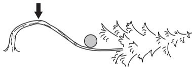
Avgör hur du säkrast frigör spänningen och om du klarar av att göra det. Vid extra komplicerade situationer är den enda säkra metoden att avstå från motorsågsanvändning och använda en vinsk.
