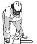
**OBSERVERA!** Drag inte ut startlinan helt och släpp inte heller starthandtaget från helt utdraget läge. Detta kan orsaka skador på maskinen.
