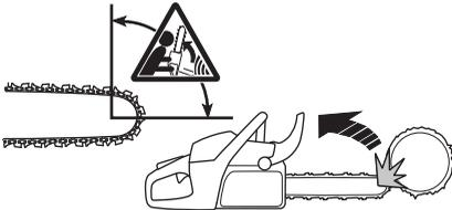
At save med sværdets underside, dvs. save fra objektets overside og ned, kaldes at save med trækkende savkæde. Da trækkes motorsaven mod træet og motorsavskroppens forkant bliver en naturlig støtte mod stammen. Savning med trækkende savkæde giver brugeren bedre kontrol over motorsaven, og man ved, hvor sværdets kastrisikoområde befinder sig.
