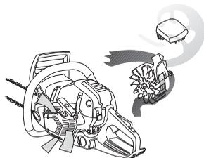
**VIGTIG!** For å opprettholde sentrifugalrensingens funksjon, må den rengjøres og vedlikeholdes kontinuerlig. Rengjør luftinntaket til startmotoren, vifteskivene på svinghjulet, rommet rundt svinghjulet, inntaksrøret og forgasserrommet.
