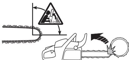
Å sage med sverdetes underside, dvs. å sage fra sagobjektets overside og ned, kalles å sage med dragende sagkjede. Da dras motorsagen mot treet, og motorsagkroppens forkant blir en naturlig støtte mot stammen. Saging med dragende sagkjede gir brukeren bedre kontroll over motorsagen og over hvor sverdetes kastrisikosektor befinner seg.
