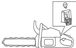
**HUOM!** Käynnistys-/pysäytyskosketin palautuu automaattisesti käyttöasentoon. Sen vuoksi tahaton käynnistyminen on aina estettävä irrottamalla sytytystulpan suojus sytytystulpasta asennuksen, tarkastuksen ja/tai huollon ajaksi.
