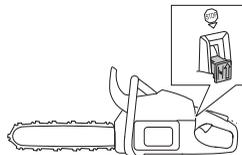
**BEMÆRK!** Start/Stop-kontakten går automatisk tilbage til køreposition. For at undgå utilsigtet start skal tændhætten altid fjernes fra tændrøret, når maskinen ikke er under opsyn.
