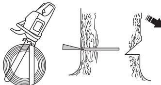
Fældesnittet skal afsluttes parallelt med retningsssnitlinjen, så afstanden mellem de to er mindst 1/10 af stammens diameter. Den ikke gennemsavede del af stammen kaldes brudpunktet.
