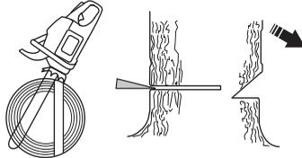
Kaatosahauksen on päättyävä samansuuntaisesti kaatoloviliinjan nähden, niin että niiden väliin jää vähintään 1/10 rungon läpimitasta. Läpisaamaatonta rungon osaa kutsutaan pitopuiksi.
