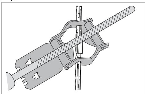
4. Odstráňte materiál z jednej strany všetkých rezacích zubov.
