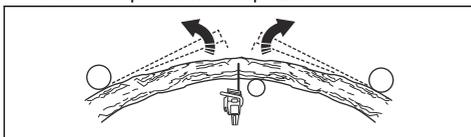
5. Vytvořte jeden nebo více řezů s dostatečnou hloubkou, které sníží napružení. Řežte v bodě nebo poblíž bodu maximálního napružení. Nechte strom nebo větev rozlomit v bodu maximálního napružení.
