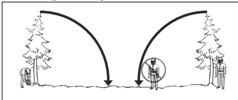
2. Gondoskodjon arról, hogy a veszélyzónában senki ne tartózkodjon sem a fadöntés előtt, sem aközben.
