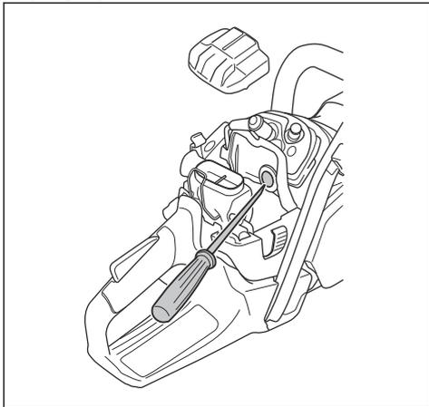
3. Dla temperatur poniżej -5°C/23°F i/lub opadów śniegu wymagane jest zamontowanie osłony zimowej. Założyć osłonę zimową na obudowie rozrusznika. Zimowa osłona zmniejsza przepływ chłodnego powietrza i utrzymuje duże ilości śniegu z dala od gaźnika.
