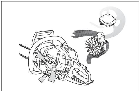
1. Tisztítsa meg kefével a hűtőrendszert hetente egyszer, illetve szükség esetén ennél gyakrabban.
