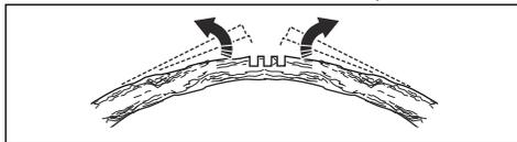
8. Po uvolnění napružení přefřízněte strom/větev z opačné strany ohybu.
