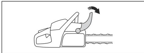
2. Vytažením vypínače (A) ven a nahoru jej nastavte do polohy sytiče.
