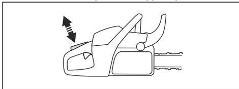
3. Uistite sa, že je páčka plynu zablokovaná v polohe voľnobehu, keď je poistka páčky plynu uvoľnená.
