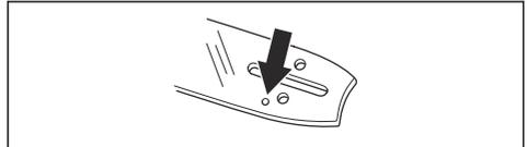
2. Zkontrolujte, zda nejsou na hraně vodicí lišty otřepy. Odstraňte otřepy pomocí pilníku.
