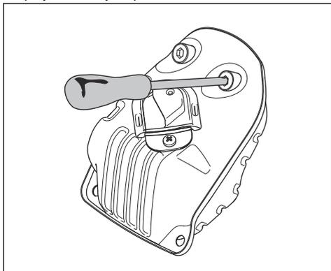
3. Jeśli produkt jest wyposażony w specjalną siatkę przeciwiskrową, należy czyścić ją co tydzień.
