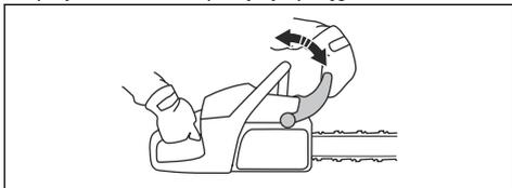
3. Trzymać urządzenie dwiema rękami nad pieńkiem lub inną stabilną powierzchnią.
