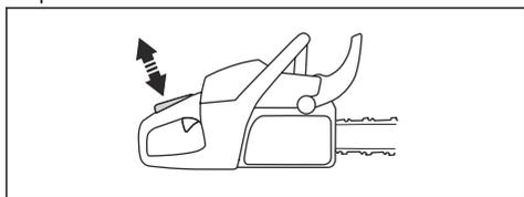
3. Sprawdzić, czy spust przepustnicy jest zablokowany w położeniu biegu jałowego po zwolnieniu jego blokady.
