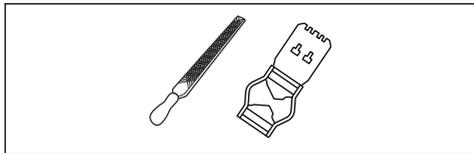
1. Lapos reszelőt és mélységátaroló eszközt használjon a vágásmélység-beállításához. A mélységátaroló beállításához kizárólag Husqvarna sablont használjon, hogy a távolságot pontosan tudja lemérni, és a helyes oldalszöveget tudja elérni.
