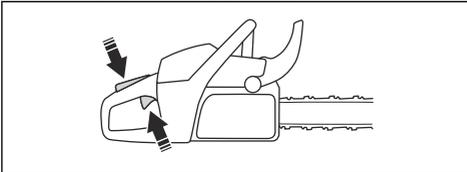
8. Pociągnąć dźwignię hamulca do tyłu, aby zwolnić hamulec piły łańcuchowej.
