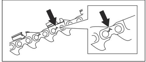
2. Zkontrolujte, zda se řetěz pily snadno ohýbá ve spojích článků. Vyměňte řetěz pily, pokud je příliš tuhý.
