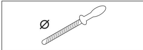
Trudno naostrzyć łańcuch tnący bez odpowiednich narzędzi. Użyć prowadnika pilnika Husqvarna. Pomoże on utrzymać maksymalną wydajność cięcia i minimalne ryzyko odbicia.
