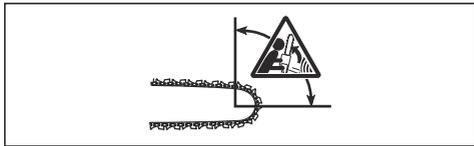
Spätný náraz vždy vzniká v reznej časti vodiacej lišty. Zvyčajne dôjde k odhodeniu výrobku voči obsluhujúcemu pracovníkovi, môže však dôjsť k jeho pohybu aj iným smerom. Smer pohybu ovplyvňuje spôsob používania výrobku v okamihu výskytu spätného nárazu.
