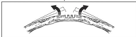
8. Po uvoľnení pnutia režte strom/konár z opačnej strany ohybu.
