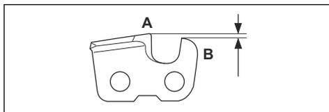
Při ostření frézovacích zubů zohledněte následující informace:
