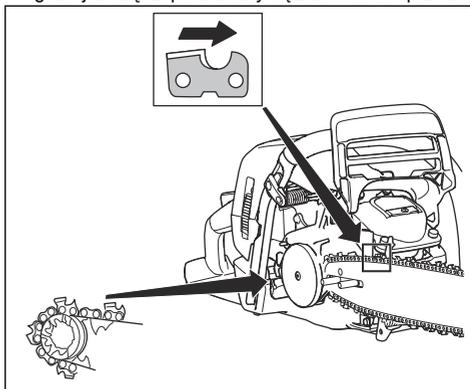
6. Wyrównać otwór w prowadnicy z trzpieniem napinacza łańcucha i zamontować osłonę sprzęgła.
