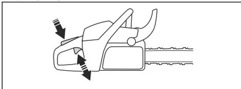
2. Nyomja le a gázadagoló reteszét, és győződjön meg arról, hogy a felengedése után visszatér alaphelyzetbe.
