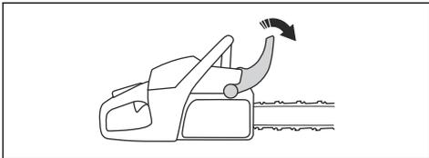
2. Wyciągnąć przełącznik start/stop (A) i pociągnąć go do góry, aby ustawić go w pozycji ssania.
