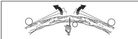
5. Vykonajte jeden alebo viacero rezov s dostatočnou hĺbkou, ktoré sú potrebné na zmenšenie pnutia. Režte v bode maximálneho pnutia alebo v jeho blízkosti. Dosiahnite, aby sa strom alebo konár v bode maximálneho pnutia zlomil.
