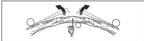
5. Ejtsen egy vagy több megfelelő mélységű vágást a feszültség csökkentése érdekében. A törési ponton vagy ahhoz közel ejtsen vágásokat. Ügyeljen arra, hogy a fa vagy ág a törési ponton törjön el.
