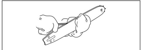
4. Zkontrolujte, zda není vodící lišta opotřebená. V případě potřeby zapalovací svíčku vyměňte.
