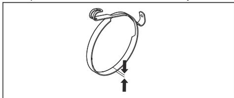
2. Zkontrolujte pás brzdy. Pás brzdy musí být v nejtěsnějším místě silný alespoň 0,6 mm (0,024 palce).
