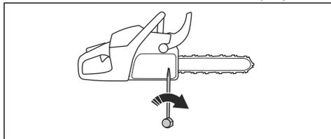
5. Dotáhněte matice vodící lišty pomocí klíče a zároveň zvedněte přední část vodící lišty.
