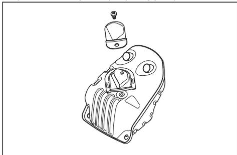
4. Wymienić uszkodzoną siatkę przeciwiskrową.
