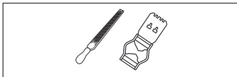
1. Na nastavenie mierky hĺbky použite plochý pilník a mierku hĺbky obmedzovacích zubov. Pri meraní hĺbky rezu používajte len mierku hĺbky obmedzovacích zubov Husqvarna, aby sa zaistila správna hĺbka rezu a správny uhol na vodiacej ploche.
