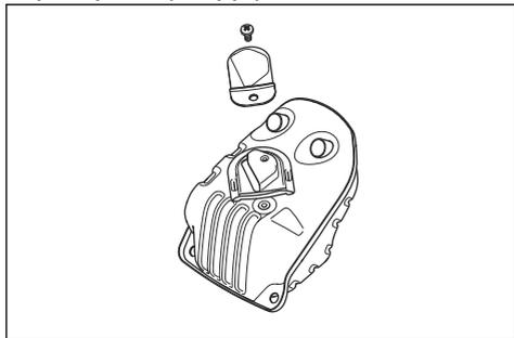
4. Vyměňte poškozený lapač jisker.
