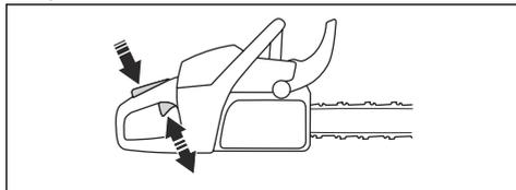
2. Stiskněte pojistku páčky plynu a zkontrolujte, zda se po uvolnění vrátí do své výchozí polohy.
