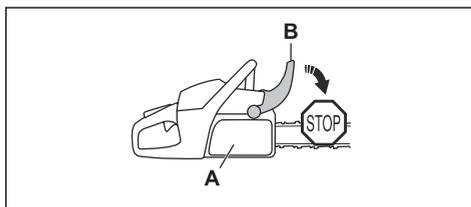
Pociągnąć zabezpieczenie przed odbiciem do tyłu, aby wyłączyć hamulec łańcucha.
