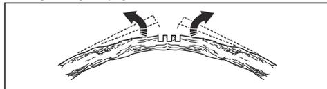
8. Po zwolnieniu naprężenia ciąć drzewo/gałęź po stronie przeciwnej do zgięcia.
