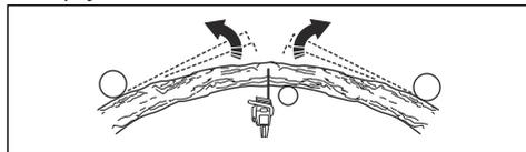
5. Wykonać jeden lub więcej rzązów o odpowiedniej głębokości w celu zmniejszenia naprężenia. Wykonać cięcie w punkcie przełamania lub w jego pobliżu. Doprowadzić do złamania drzewa lub gałęzi w punkcie maksymalnego naprężenia.
