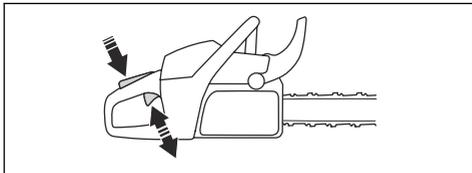
2. Stlačte poistku páčky plynu a uistite sa, či sa po uvoľnení vráti do východiskovej polohy.
