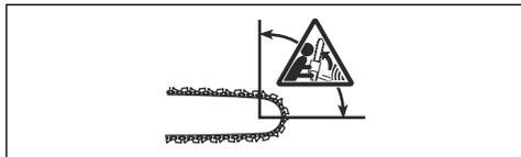
Odbicie powstaje zawsze w płaszczyźnie tnącej prowadnicy. Zazwyczaj produkt jest wyrzucany w stronę operatora, ale kierunek odbicia może też być inny. Kierunek ruchu odbicia jest zależny od sposobu używania produktu w momencie odbicia.
