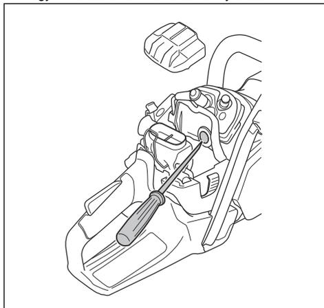
3. A -5 °C/23 °F alatti hőmérséklethez vagy havas körülményekhez egy téli takarólap áll rendelkezésre. Szerelje fel a téli takarólapot az indítószerkezet házára. A téli takarólap csökkenti a hideg levegő beáramlását, illetve megakadályozza, hogy hó kerüljön a porlasztótérbe.
