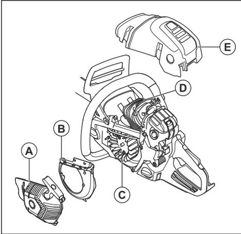
1. Reinigen Sie das Kühlsystem wöchentlich oder bei Bedarf häufiger mit einer Bürste.
