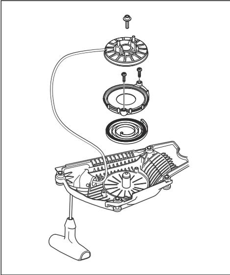
6. Stellen Sie sicher, dass Sie die Riemenscheibe noch  $\frac{1}{2}$  Umdrehung drehen können, nachdem das Startseil vollständig ausgefahren ist.
