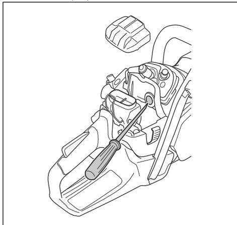
3. Za temperature pod -5 °C/23 °F ali snežne razmere je na voljo pokrov za zimske razmere. Pokrov za zimske razmere namestite na ohišje zaganjalnika. Pokrov za zimske razmere zmanjšuje pretok hladilnega zraka in sneg zadržuje zunaj prostora uplinjalnika.
