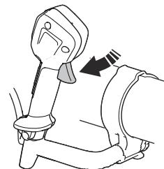
2. Stisknutím tlačítka Cruise control nastavte zvolený průtok vzduchu. Rozsvítí se kontrolka LED.
