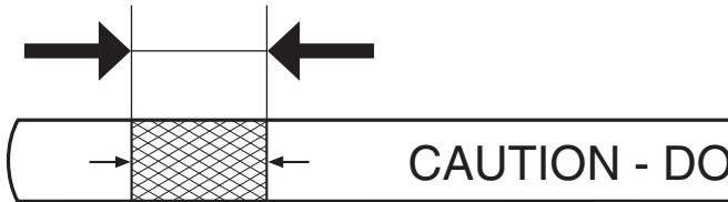
**SE** Oljenivån skall ligga mellan de två markeringarna på oljestickan. Fyll vid behov på olja upp till den rutmönstrade markeringen på mätsstickan. Se avsnittet "PRODUKTSPECIFIKATIONER" i bruksanvisningen för ungefärlig kapacitet och oljetyp. Överfyll inte.
