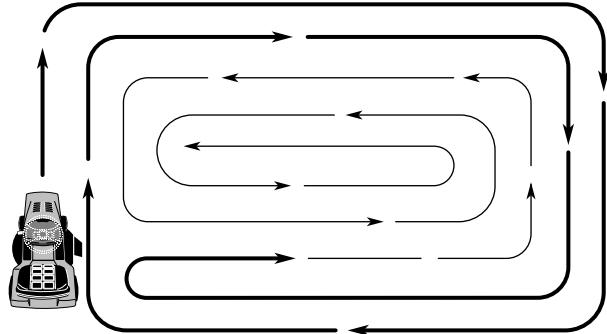
**(SE) ADVARSEL!** Använd maskinens vänstra sida för att kunna klippa nära träd, buskar, gångare etc. Kniven klipper ca 15 mm innanför kåpanskant.
