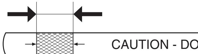
SE Oljenivån skall ligga mellan de två markeringarna på oljestickan. Fyll vid behov på olja upp till den rutmönstrade markeringen på mätstickan. Se avsnittet "PRODUKTSPECIFIKATIONER" i bruksanvisningen för ungefärlig kapacitet och oljetyp. Överfyll inte.
