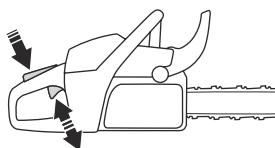
2. Stlačte pojistku páčky plynu a uistite sa, či sa po uvoľnení vráti do východiskovej polohy.
