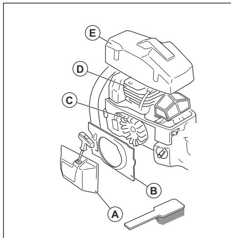
1. Tisztítsa meg kefével a hűtőrendszert hetente egyszer, illetve szükség esetén ennél gyakrabban.
