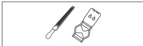
1. Pomocí plochého pilníku a měrky snížení omezovacích zubů upravte nastavení výšky omezovacích zubů. Používejte výhradně měrku snížení omezovacích zubů Husqvarna. Docilete tak správné výšky omezovacích zubů a správného úhlu hrany omezovacích zubů.
