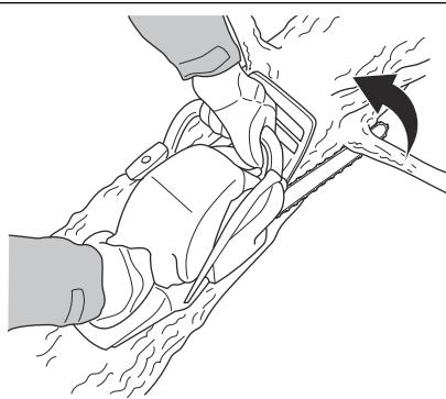
**VÝSTRAHA:** Ak reťaz pily uviazne v kmeni, zastavte motor. Pomocou páky otvorte škáru a výrobok uvoľnite.
