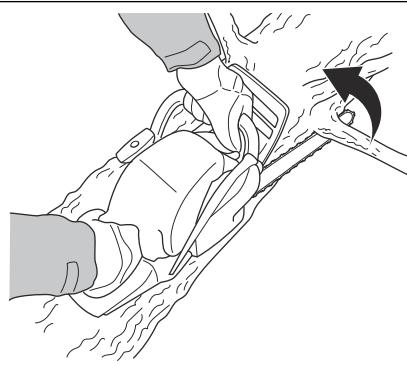
**VÝSTRAHA:** Pokud se řetěz pily zachytí v kmene, vypněte motor. Pomoci páky rozevřete řez a vyjměte výrobek. Nepokoušejte se vytáhnout výrobek rukou. Může dojít ke zranění při náhlém uvolnění výrobku.
