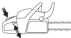
2. Stiskněte pojistku páčky plynu a zkontrolujte, zda se po uvolnění vrátí do své výchozí polohy.
