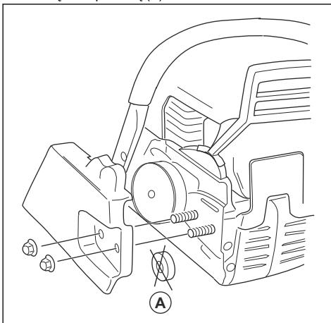
**Uwaga:** Jeśli osłona spręgła jest trudna do zdjęcia, dokręcić nakrętkę prowadnicy, włączyć hamulec piły łańcuchowej i zwolnić ponownie. Podczas prawidłowego zwolnienia słyszalne jest kliknięcie.
