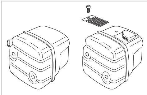
4. Wymienić uszkodzoną siatkę przeciwickową.
