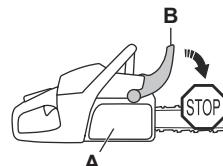
Pociągnąć zabezpieczenie przed odbiciem do tyłu, aby wyłączyć hamulec łańcucha.
