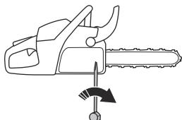
5. Dotáhněte matice vodicí lišty pomocí klíče a zároveň zvedněte přední část vodicí lišty.
