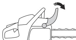
2. Przesunąć przełącznik start/stop do położenia włączenia.
