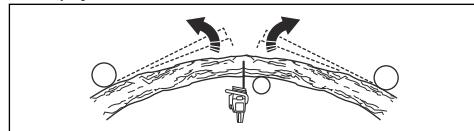
5. Wykonać jeden lub więcej razy o odpowiedniej głębokości w celu zmniejszenia naprężenia. Wykonać cięcie w punkcie przełamania lub w jego pobliżu. Doprowadzić do złamania drzewa lub gałęzi w punkcie maksymalnego naprężenia.
