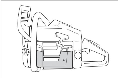
**VIGYÁZAT:** Ha a hőmérséklet 0°C/32°F fölött emelkedik, távolítsa el a téli takarólapot. Túl magas motorhőmérséklet és a motor károsodásának veszélye áll fenn.
