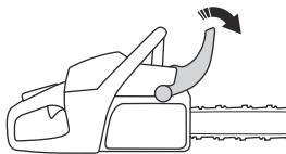
2. Przesunąć przełącznik start/stop do położenia włączenia.
