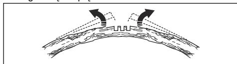
8. Po zwolnieniu naprężenia ciąć drzewo/gałaz po stronie przeciwniej do zgięcia.
