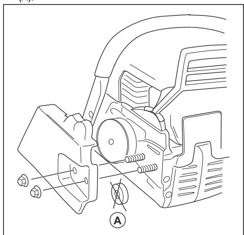
**Povšimněte si:** Pokud nelze kryt spojky snadno sejmout, dotáhněte matici lišty, aktivujte brzdu řetězu a poté ji uvolněte. Při správném uvolnění se ozve cvaknutí.
