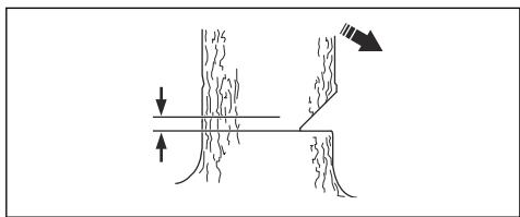
**OSTRZEŻENIE:** Zachować ostrożność podczas cięcia przy użyciu wierzchołka prowadnicy. Rozpocząć cięcie dolną częścią wierzchołka prowadnicy tak, jak przy wykonywaniu otworu w pniu.
