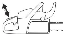
3. Uistite sa, že je páčka plynu zablokovaná v polohe voľnobehu, keď je pojistka páčky plynu uvoľnená.
