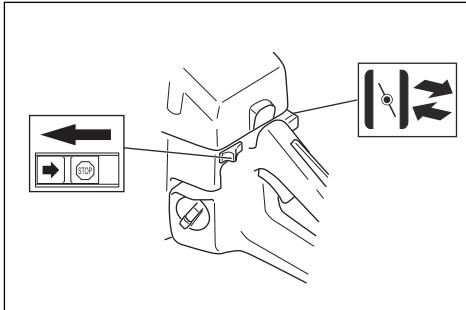
4. Nyomja be a nyomáscsökkentő szelepet.
