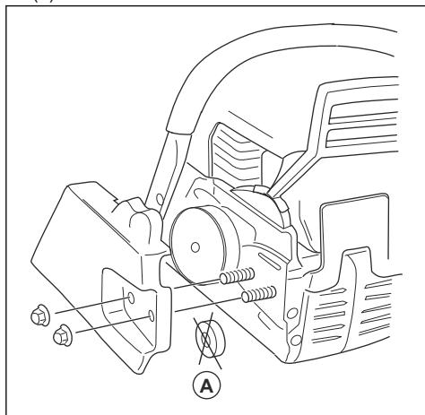
**Megjegyzés:** Amennyiben a tengelykapcsoló fedelének eltávolítása nehézségekbe ütközik, szorítsa meg a vezetőlemez rögzítő anyacsavart, és kapcsolja be, majd engedje ki a láncfékét. Megfelelő kiengedés esetén kattanás hallható.
