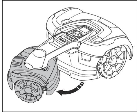
3. Legen Sie einen Schutz zwischen die Abdeckung und den Verbindungsarm. Dadurch werden Schäden an der oberen Abdeckung vermieden.
