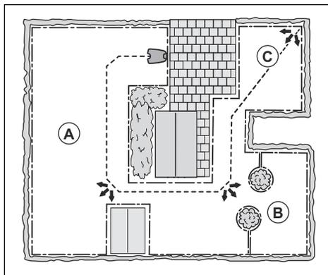
Jeder Bereich kann aktiviert oder deaktiviert werden. Verwenden Sie die *Testfunktion* zum Messen der Entfernung von der Ladestation bis zu dem Punkt, an dem das Gerät zu mähen beginnt.
