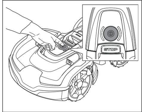
2. Drücken Sie die **ON/OFF**-Taste 3 Sekunden lang, um das Gerät auszuschalten.
