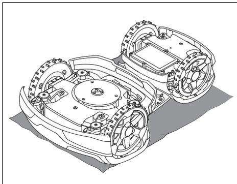
3. Entfernen Sie die 6 Schrauben und nehmen Sie die Akku-Abdeckung ab.
