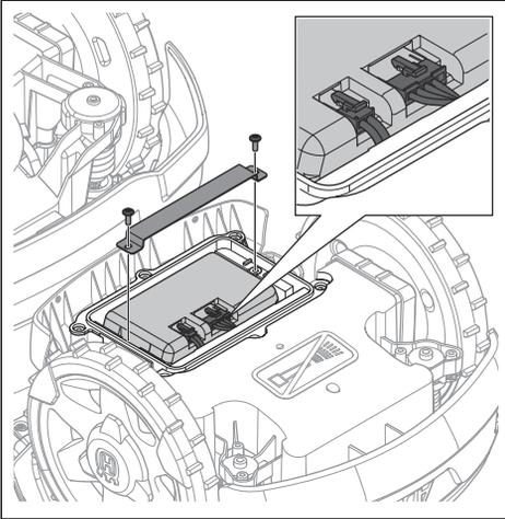
5. Entfernen Sie die beiden Kabel vom Akku und nehmen Sie den Akku heraus.
