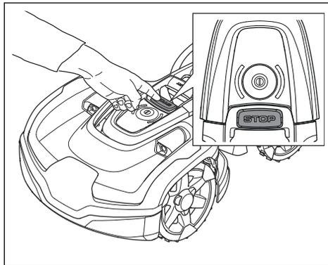
Das Gerät hält an, und der Schneidmotor kommt zum Stillstand.
