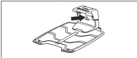
2. Wenn die LED-Anzeigelampe nicht grün leuchtet, führen Sie eine Überprüfung der Installation durch. Siehe *LED Anzeigelampe der Ladestation auf Seite 43* und *Installieren der Ladestation auf Seite 18*.
