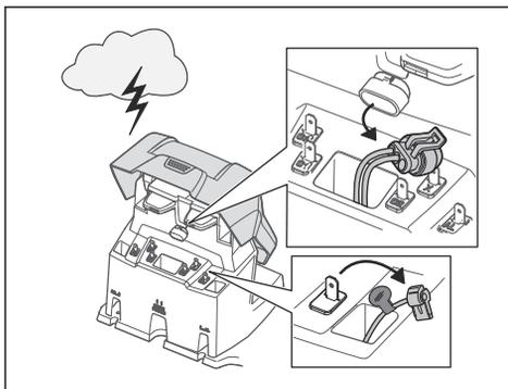
Um das Risiko der Beschädigung von Komponenten im Gerät und der Ladestation zu verringern, empfehlen wir, bei Gewittergefahr alle Verbindungen zur Ladestation (Netzteil, Begrenzungskabel und Leitkabel) zu trennen.
