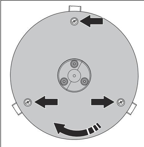
5. Entfernen Sie die 3 Schrauben. Verwenden Sie dafür einen manuellen Schlitz- oder Kreuzschraubendreher.
