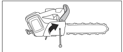
4. Ziehen Sie die Spannmutter mit dem Kombischlüssel an, und heben Sie gleichzeitig die Vorderseite der Führungsschiene an.
