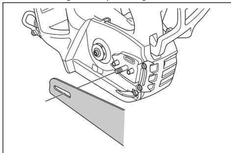
4. Duw de geleider volledig in de achterste positie. Til de zaagketting boven het kettingaandrijf wiel en positioneer de ketting in de groef van de geleider. Begin aan de bovenzijde van de geleider.
