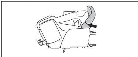
2. Stellen Sie sicher, dass der Handschutz sich frei bewegen lässt und sicher am Gerät befestigt ist.
