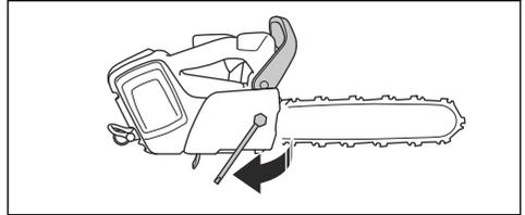
5. Controleer of de zaagketting gemakkelijk met de hand kan worden rondgedraaid en of deze niet doorhangt aan de onderkant van het zaagblad.
