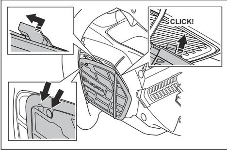
3. Poussez le capot de prise d'air vers la gauche jusqu'à ce que les orifices soient alignés.
