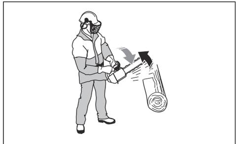
Verwenden Sie die Kettenbremse als Feststellbremse, wenn Sie das Gerät starten und sich über kurze Strecken bewegen. Dadurch reduzieren Sie das Risiko,
