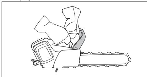
3. Faites tourner à puissance maximum et inclinez le poignet gauche vers l'avant pour serrer le frein de chaîne.
