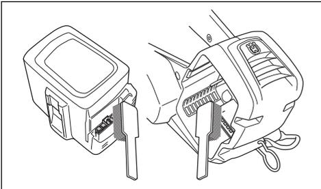
3. Stellen Sie sicher, dass der Akku nicht beschädigt oder verformt ist und dass keine sonstigen Schäden wie zum Beispiel Risse vorhanden sind.
