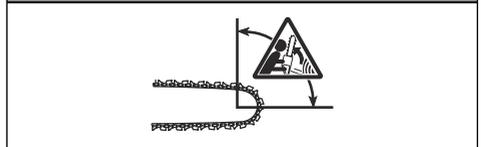
Die Art und Weise, wie die Kettenbremse aktiviert wird, hängt von der Kraft des Rückschlags und der Position des Geräts ab. Bei einem heftigen Rückschlag und wenn sich der Rückschlagbereich so weit wie möglich von Ihnen entfernt befindet, wird die Kettenbremse durch die Trägheitsfunktion aktiviert. Bei einem leichten Rückschlag oder bei einem Rückschlag in Ihrer Nähe wird die Kettenbremse manuell von Ihrer linken Hand aktiviert.
