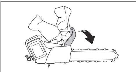
In der Fällposition können Sie die Kettenbremse nicht manuell aktivieren. In dieser Position lässt sich die Kettenbremse nur mit der Trägheitsfunktion aktivieren.
