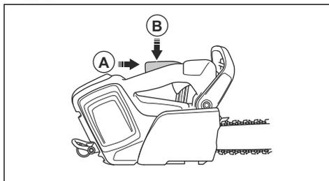
3. Stellen Sie sicher, dass der Gashebel in der Leerlaufposition verriegelt ist, wenn die Gashebelsperre freigegeben wird.
