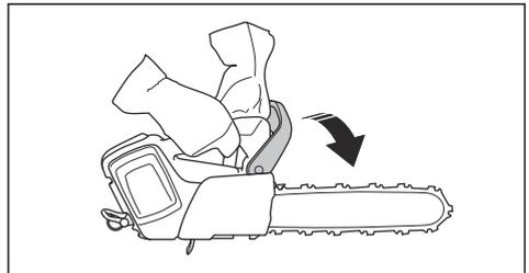
In de velpositie kunt u de kettingrem niet handmatig inschakelen. De kettingrem kan in deze stand alleen worden ingeschakeld door het traagheidsmechanisme.
