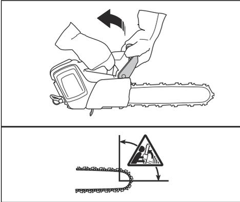
Hoe de kettingrem wordt ingeschakeld, hangt af van de kracht van de terugslag en de positie van het product. Als u een intense terugslag ervaart terwijl de terugslagzone zich op het verste punt van u vandaan bevindt, wordt de kettingrem ingeschakeld door het traagheidsmechanisme. Als de terugslag niet sterk is of als de terugslagzone zich dicht bij u in de buurt bevindt, schakelt u de kettingrem handmatig in met uw linkerhand.
