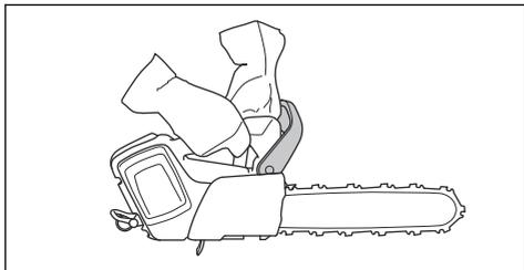
3. Bringen Sie das Gerät auf volle Leistung und aktivieren Sie die Kettenbremse.
