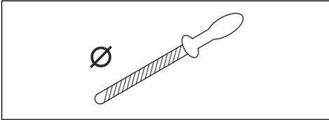
Het is niet gemakkelijk om zonder de juiste hulpmiddelen een zaagketting correct te slijpen. Gebruik een Husqvarna-vijlmal. Hiermee zorgt u voor maximale zaagprestaties en beperkt u het risico op terugslag.
