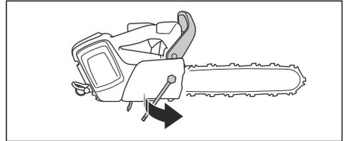
2. Heben Sie die Spitze der Führungsschiene an und drehen Sie die Kettenspannschraube. Benutzen Sie dazu den Kombischlüssel.
