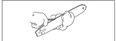
4. Examinez l'usure de la rainure du guide-chaîne. Remplacez le guide-chaîne si nécessaire.
