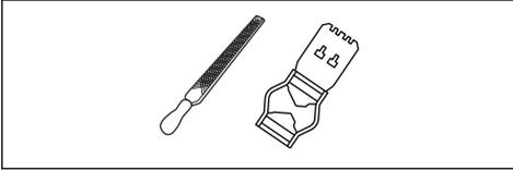
1. Gebruik een platte vijl en een vijlmal om de hoogte van de dieptesteller aan te passen. Gebruik alleen een Husqvarna-vijlmal om de juiste tanddiepte en vijlhoek te verkrijgen.
