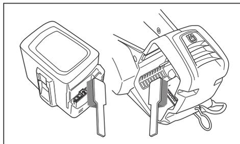
3. Vérifiez que la batterie n'est pas endommagée et ne présente aucun défaut apparent (fissure, etc.).
