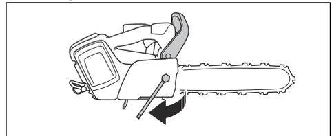
5. Stellen Sie sicher, dass sich die Sägekette leicht von Hand bewegen lässt, aber nicht von der Führungsschiene herabhängt.
