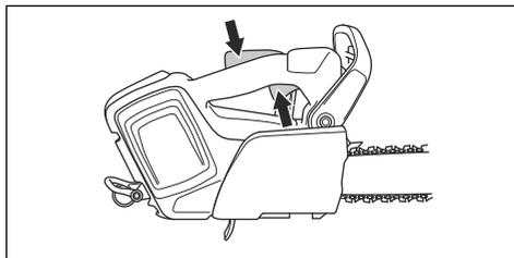
2. Drücken Sie die Gashebelsperre nach vorne (A) und nach unten (B). Halten Sie die Gashebelsperre gegen den Griff, und stellen Sie sicher, dass sie in ihre Ausgangsstellung zurückkehrt, sobald sie gelöst wird.
