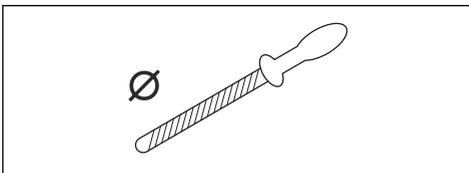
Ohne Hilfsmittel ist es nicht leicht, eine Sägekette korrekt zu schärfen. Verwenden Sie Husqvarna Schärflehre. Dies hilft Ihnen, die maximale Schnittleistung zu erhalten und die Rückschlaggefahr auf ein Minimum zu reduzieren.
