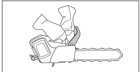
De terugslagbeveiliging verlaagt ook het risico op het raken van de zaagketting als u uw hand van de voorste handgreep afhaalt.
