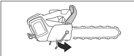
2. Til de voorkant van de geleider op en draai de stelschroef van de ketting aan. Gebruik de combinatie tang.
