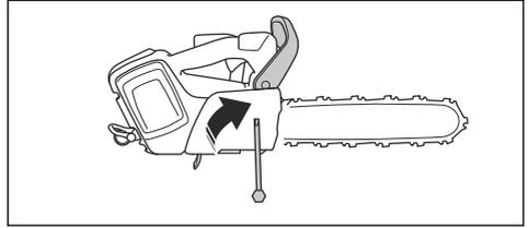
4. Draai de zaagbladmoer vast met de combinatiesleutel en til hierbij tegelijkertijd de voorzijde van het zaagblad omhoog.
