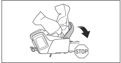
Bewegen Sie den Handschutz nach hinten, um die Kettenbremse zu lösen.
