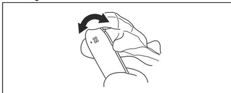
7. Draai de geleider dagelijks om de levensduur te verlengen.
