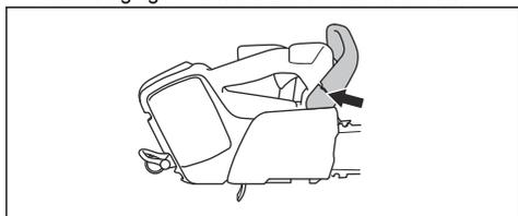
2. Zorg ervoor dat de terugslagbeveiliging vrij beweegt en dat deze veilig op het product is bevestigd.
