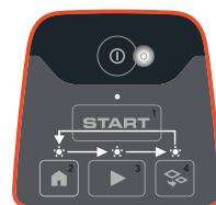
Firmwareinstallationen er i gang
