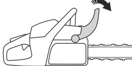
2. Tirez l'interrupteur marche/arrêt (A) vers vous puis vers le haut pour le mettre en position de démarrage.
