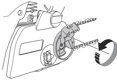
3. Draai het kettingspannerwiel naar onderen (+) om de spanning van de zaagketting te verhogen. Draai het kettingspannerwiel naar boven (-) om de spanning van de zaagketting te verlagen.
