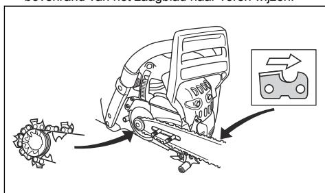
6. Lijn het gat in het zaagblad uit met de stelpen van de kettingspanner en plaats het koppelingsdeksel.
