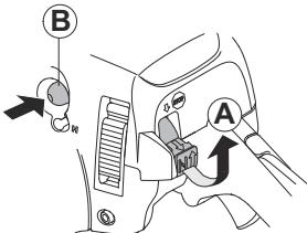
3. Appuyez environ 6 fois sur la poire de la pompe à carburant (B) ou jusqu'à ce qu'elle commence à se remplir de carburant. Il n'est pas nécessaire de remplir entièrement la poire de la pompe à carburant.
