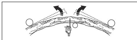
5. Machen Sie einen oder mehrere Schnitte so tief wie erforderlich, um die Spannung zu verringern. Sägen Sie am oder in der Nähe des Punktes mit der stärksten Spannung. Lassen Sie den Baumstamm oder Ast an dem Punkt mit der stärksten Spannung brechen.
