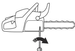
5. Ziehen Sie die Muttern der Führungsschiene mit dem Zoll-Schraubenschlüssel an, und heben Sie gleichzeitig die Vorderseite der Führungsschiene an.
