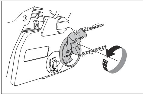
3. Tournez la molette du tendeur de chaîne vers le bas (+) pour augmenter la tension de la chaîne. Tournez la molette du tendeur de chaîne vers le haut (-) pour diminuer la tension de la chaîne.
