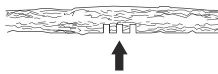
7. Blijf zagen tot de boom/tak buigt en de spanning wordt afgelaten.
