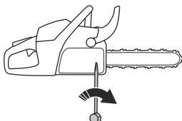
5. Draai de zaagbladmoeren vast met de moersleutel en til hierbij tegelijkertijd de voorzijde van het zaagblad omhoog.
