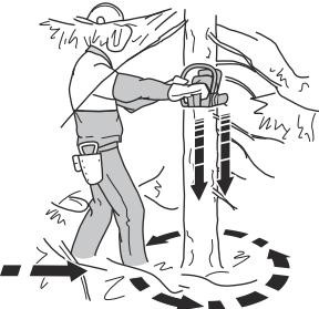
2. Entfernen Sie Unterholz aus dem Arbeitsbereich um den Baum. Entfernen Sie alle gesägten Teile aus dem Arbeitsbereich.
