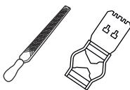
1. Pour ajuster le réglage de la jauge de profondeur, utilisez une lime plate et un outil de jauge de profondeur. Utilisez uniquement un outil de jauge de profondeur recommandé Husqvarna pour obtenir le bon réglage et le bon angle pour la jauge de profondeur.
