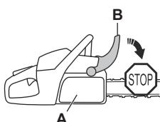
Bewegen Sie den Handschutz nach hinten, um die Kettenbremse zu lösen.
