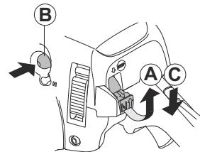
3. Drücken Sie die Kraftstoffpumpe (B) ca. 6 Mal, bis sich die Pumpe mit Kraftstoff füllt. Es ist nicht erforderlich, die Kraftstoffpumpenblase vollständig zu füllen.
