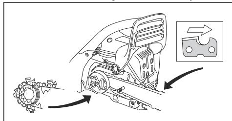
6. Lijn het gat in het zaagblad uit met de stelpen van de kettingspanner en plaats het koppelingsdeksel.
