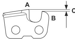
**AVERTISSEMENT:** Le risque de rebond augmente si le réglage de la jauge de profondeur est trop important !
