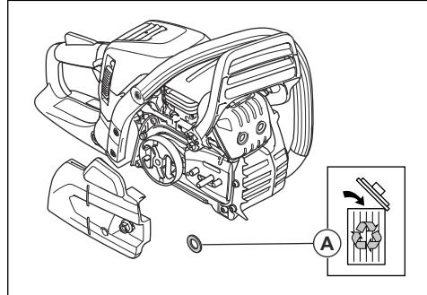
**Let op:** Als het koppelingsdeksel moeilijk te verwijderen is, draait u de zaagbladmoer aan en schakelt u de kettingrem in en weer uit. U hoort een klik als de kettingrem goed vrijkomt.
