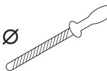
Het is niet makkelijk om zonder de juiste hulpmiddelen een zaagketting correct te slijpen. Gebruik een Husqvarna aanbevolen vijfmal. Deze helpt u om optimale zaagprestaties te bereiken en het risico op terugslag tot een minimum te beperken.
