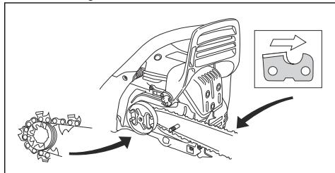
6. Richten Sie das Loch in der Führungsschiene an dem Stift der Ketteneinstellung aus, und befestigen Sie den Kupplungsdeckel.
