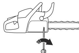
5. Serrez les écrous du guide-chaîne à l'aide de la clé et soulevez en même temps l'extrémité avant du guide-chaîne.
