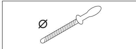
Ohne Hilfsmittel ist es nicht leicht, eine Sägekette korrekt zu schärfen. Verwenden Sie eine Husqvarna empfohlene Schärflehre. Dies hilft Ihnen, die maximale Schneidleistung zu erhalten und die Rückschlaggefahr auf ein Minimum zu reduzieren.
