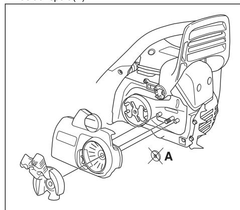
**Remarque:** Si le carter d'embrayage est difficile à retirer, serrez l'écrou du guide-chaîne, serrez le frein de chaîne, puis desserrez-le. Vous entendez un clic lorsqu'il est desserré correctement.
