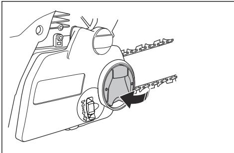
6. Controleer of de zaagketting gemakkelijk met de hand kan worden rondgedraaid en of deze niet doorhangt aan de onderkant van het zaagblad.
