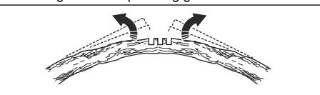
8. Sägen Sie den Baum/Ast von der anderen Seite der Biegung, nachdem die Spannung gelöst ist.
