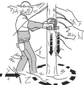
2. Zorg dat de werkomgeving rond de boom vrij is van ondergroei. Verwijder het afgezaagde materiaal uit de werkomgeving.
