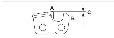
**WAARSCHUWING:** Een te hoge dieptesteller vergroot het terugslagrisico van de ketting!
