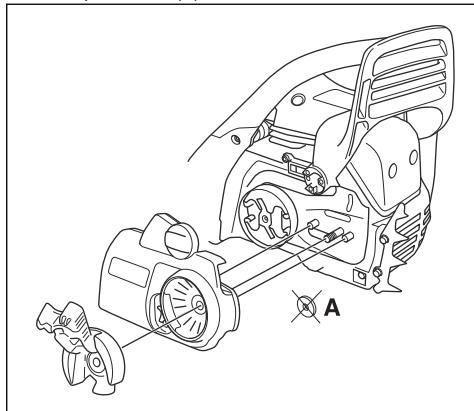
**Hinweis:** Wenn der Kupplungsdeckel nicht einfach zu entfernen ist, schrauben Sie die Schienennut fest, aktivieren Sie die Kettenbremse und lösen Sie sie wieder. Ein Klicken ist hörbar, wenn sie richtig gelöst wird.
