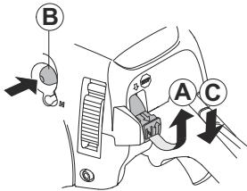
3. Appuyez environ 6 fois sur la poire de la pompe à carburant (B) ou jusqu'à ce qu'elle commence à se remplir de carburant. Il n'est pas nécessaire de remplir entièrement la poire de la pompe à carburant.
