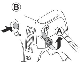
3. Drücken Sie die Kraftstoffpumpe (B) ca. 6 Mal, bis sich die Pumpe mit Kraftstoff füllt. Es ist nicht erforderlich, die Kraftstoffpumpenblase vollständig zu füllen.
