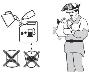
1. Füllen die Hälfte des Benzins in einen sauberen Kraftstoffbehälter.
