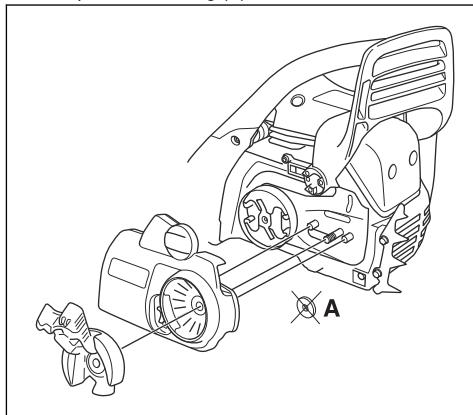
**Let op:** Als het koppelingsdeksel moeilijk te verwijderen is, draait u de zaagbladmoer aan en schakelt u de kettingrem in en weer uit. U hoort een klik als de kettingrem goed vrijkomt.
