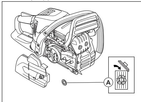
**Remarque:** Si le carter d'embrayage est difficile à retirer, serrez l'écrou du guide-chaîne, serrez le frein de chaîne, puis desserrez-le. Vous entendez un clic lorsqu'il est desserré correctement.
