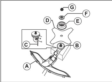
4. Entfernen Sie den Stützflansch (F), die Stützkappe (E) und die Grasklinge (D) von der Abtriebswelle.
