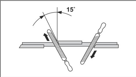
**Hinweis:** Schärfen Sie die Kanten der Zähne mit einer Flachfeile, falls die Klinge stark abgenutzt ist. Schärfen Sie danach mit einer Rundfeile weiter.
