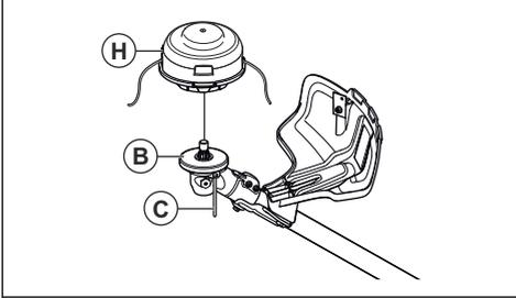
3. Stecken Sie den Sperrstift (C) in das Loch, so dass die Welle fixiert ist.
