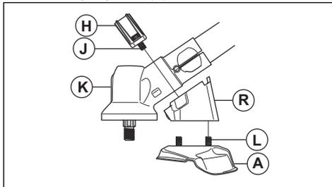
2. Odvijte oba vijaka (J) na ohišju opreme (K). Odstranite nosilec (R) in okvir (H).
