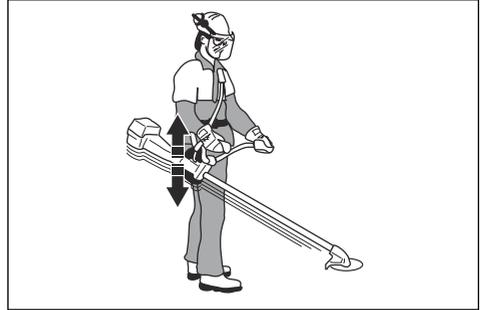
5. Wenn Gras geschnitten werden soll, lassen Sie die Schneidausrüstung leicht auf dem Boden bleiben. Stellen Sie den Tragegurthalter ein, um das Gerät korrekt auszubalancieren.
