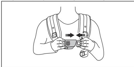
4. Če ima oprtnik kočno blazinico in bočni pas, se prepričajte, da funkcija za hitro sprostitve deluje pravilno.
