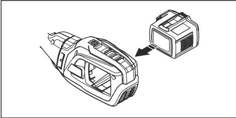
3. Stellen Sie sicher, dass der Akku richtig eingesetzt ist.
