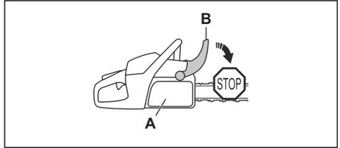
Bewegen Sie den Handschutz nach hinten, um die Kettenbremse zu lösen.
