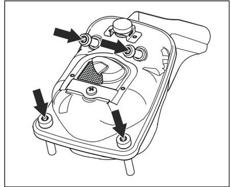
3. Če je izdelek opremljen s posebnim lovilnikom isker, ga morate čistiti enkrat tedensko.
