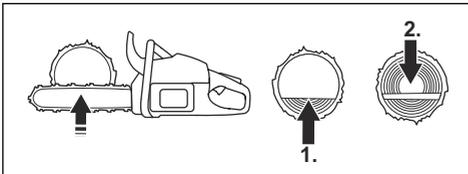
**So sägen Sie einen Stamm, der an zwei Enden gestützt wird.**
