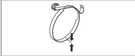
2. Prüfen Sie das Bremsband. Das Bremsband muss an der dünnsten Stelle mindestens 0,6 mm dick sein.
