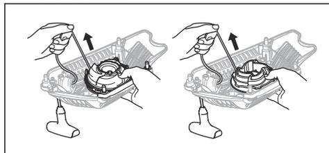
4. Lassen Sie die Riemenscheibe sich langsam nach hinten drehen, um die Rückzugfeder zu lösen.
