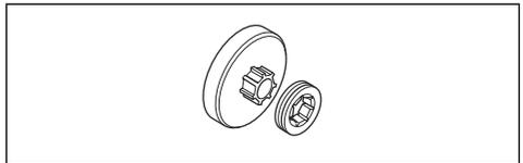
1. Stellen Sie sicher, dass kein Verschleiß am Rim-Antriebsrad vorliegt. Tauschen Sie es bei Bedarf aus.
