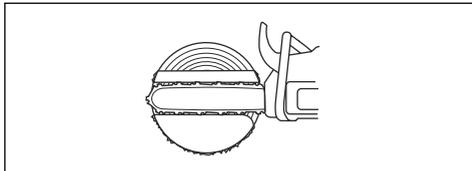
b) Žagajte z vlečenjem motorne žage, dokler ne ostane  $\frac{1}{3}$  hloda.
