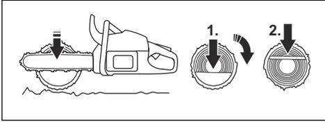
**So sägen Sie einen Stamm, der an einem Ende gestützt wird.**
