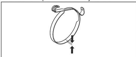
2. Preverite zavorni trak. Zavorni trak mora biti na najtanjši točki debel najmanj 0,6 mm/0,024 palca.
