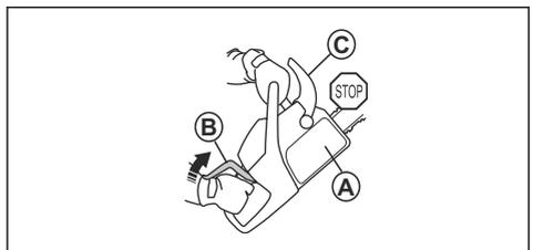
Bewegen Sie den Handschutz (C) nach hinten, um die Kettenbremse zu lösen.
