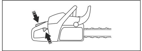
8. Bewegen Sie den Handschutz nach hinten, um die Kettenbremse zu lösen.
