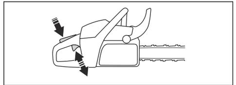
2. Prüfen Sie, ob sich der Gashebel und die Gashebelsperre frei bewegen lassen und ob die Rückholfeder korrekt funktioniert.
