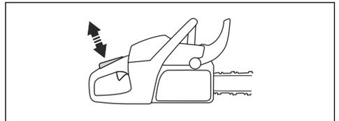
3. Stellen Sie sicher, dass der Gashebel in der Leerlaufstellung verriegelt ist, wenn die Gashebelsperre freigegeben wird.
