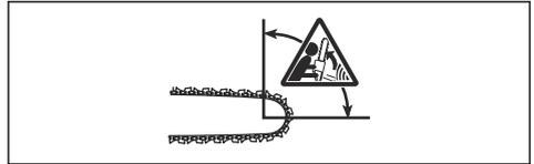
Ein Rückschlag ist immer in Richtung der Führungsschiene gerichtet. Normalerweise wird das Gerät gegen den Bediener geschleudert, manchmal aber auch in eine andere Richtung. Sie beeinflussen die Richtung der Bewegung durch Ihr Verhalten beim Auftreten des Rückschlags.
