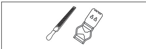
1. Nastavitev globine reza prilagodite s ploščato pilo in šablono za brušenje globinskih zob. Uporabljajte samo šablono za brušenje globinskih zob za nastavitev ustrezne globine in šablono za brušenje rezalnih zob družbe Husqvarna.
