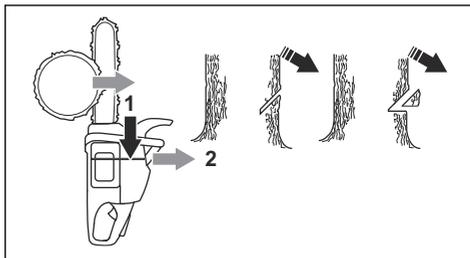
2. Stellen Sie sicher, dass der untere Kerbschnitt horizontal ausgerichtet ist und im Winkel von  $90^\circ$  Grad zur Fällrichtung ist.
