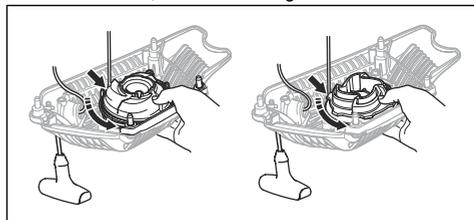
5. 545 Mark II, 545G Mark II: Bauen Sie die mittlere Schraube (A), die Hülse (B) und die Feder (C) aus.
