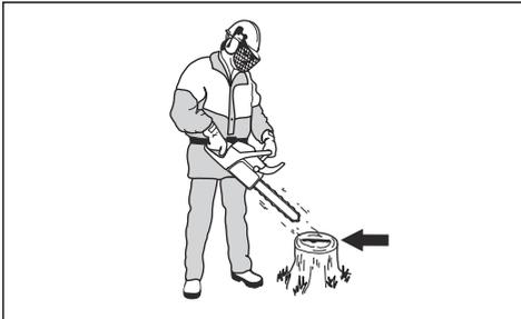
3. Wenn die Sägekettenschmierung nicht ordnungsgemäß funktioniert, führen Sie eine Prüfung der Führungsschiene durch. Eine Anleitung finden Sie in *So prüfen Sie die Führungsschiene auf Seite 34*. Wenden Sie sich an den Kundendienst, wenn Sie mit den Wartungsschritten das Problem nicht beheben können.
