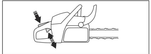
2. Prüfen Sie, ob sich der Gashebel und die Gashebelsperre frei bewegen lassen und ob die Rückholfeder korrekt funktioniert.
