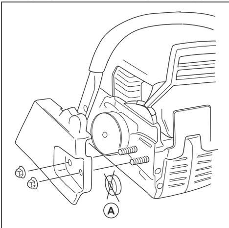
**Hinweis:** Wenn der Kupplungsdeckel nicht einfach zu entfernen ist, schrauben Sie die Schienenmutter fest, aktivieren Sie die Kettenbremse und lösen Sie sie wieder. Ein Klicken ist hörbar, wenn sie richtig gelöst wird.
